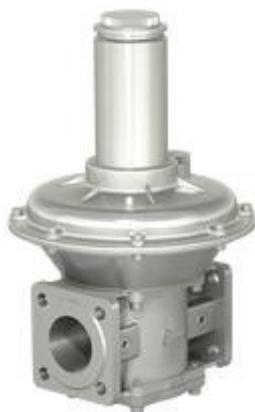
Регуляторы-стабилизаторы давления предназначены для снижения, регулирования и поддержания давления (расхода) углеводородных газов, газовых фаз сжиженных газов, сжатого воздуха и других неагрессивных газов на выходе постоянным в заданных пределах независимо от изменений входного давления и работают без использования постороннего источника энергии.
