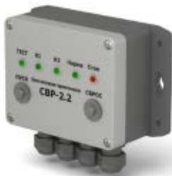
Устройство представляет собой стационарный прибор со световой индикацией. Панель устройства отображает информацию о герметичности предохранительно-запорных электромагнитных клапанов.
